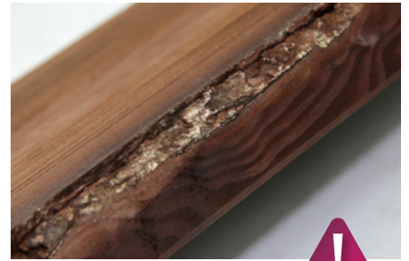
Kantenausbruchäste – kleine auf der Rückseite erlaubt
