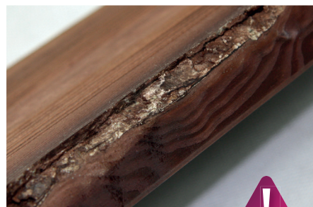
Nodi nelle scheggiature sui bordi - piccoli nodi sono consentiti sul lato posteriore
