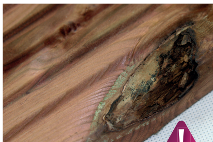
Scheggiature sui bordi - ammesse fino a 20 mm, al massimo 2 pezzi per metro lineare
